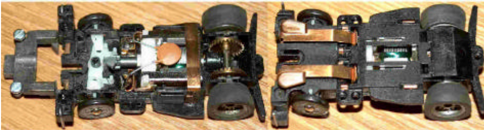
b: Spreizfederlenkung, (hier auch Lichtkerbe im Gewicht)
